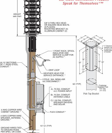
GROUND RODS \* PER SPEC, OR GROUNDING PER LOCAL CODES.
